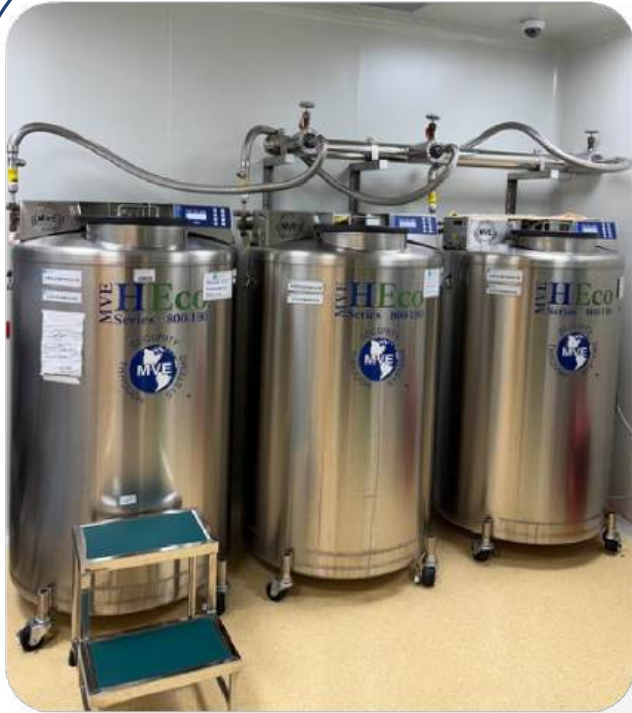
用于长期储存脐带间质干细胞得液氮储存罐
